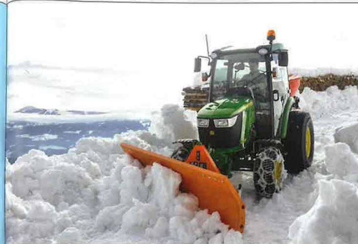
Für den Profieinsatz vorgesehen sind besonders die in Segmentbauweise konzipierten Federklappenschilder der SRM-SF Schneeräumschildreihe mit Arbeitsbreiten von 140 bis 220 cm. |
