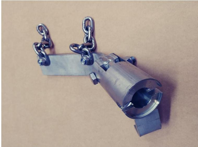
Bild 6: Kettenrührwerk
