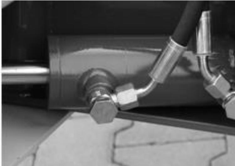
Bild 2: Ausrichtung der Winkelschwenkverschraubungen
