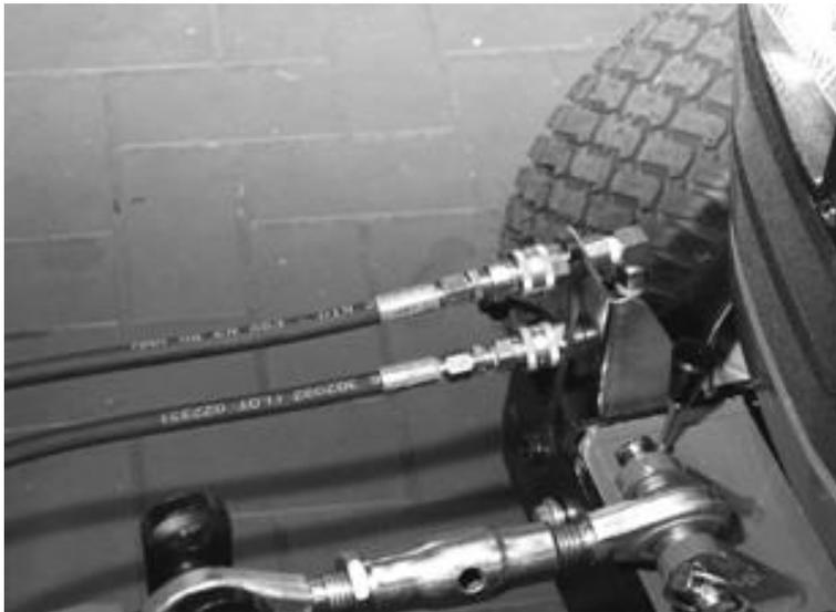
Bild 9: Anschluß der Hydraulikleitungen an die Schlepperhydraulik
