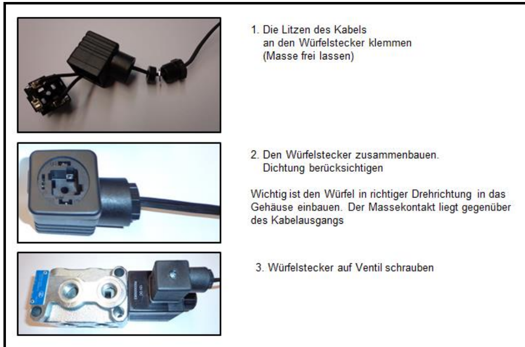
Bild 32: Umschaltventil elektrisch anschließen
