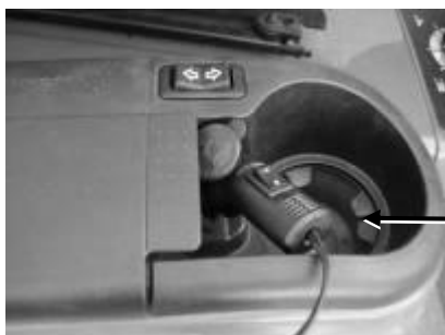
Bild 43: 12 V Anschluss mit Schalter
