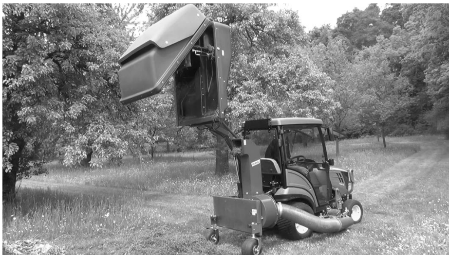
Bild 45: Hochentleerung, Deckel offen
