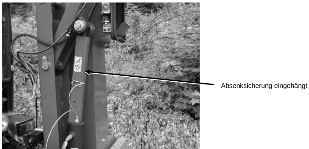
Bild 50: Absenksicherung in Stellung gesichert
