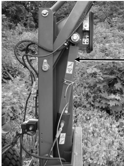
Bild 46: Absenksicherung in Stellung gesichert
