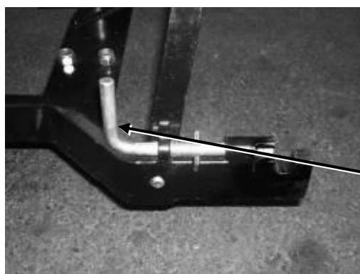
Bild 35: Sperrbolzen (entriegelt) am Unterlenker
