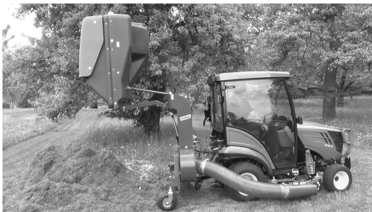
Bild 44: Hochentleerung Deckel geschlossen
