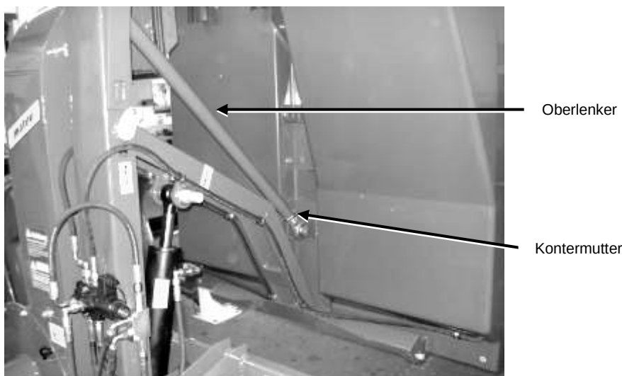
Bild 54: Oberlenker (Ansicht bei angehobenem Behälter)
