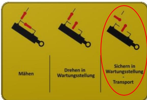
Abbildung 36: Pos. Der Absperrhähne „Sicherung in Wartungsstellung“
