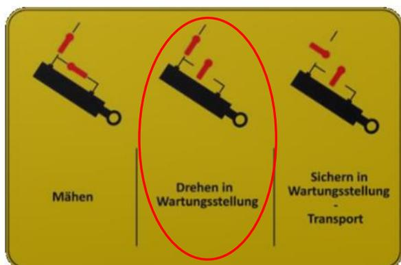
Abbildung 33: Pos. Der Absperrhähne „Drehen in Wartungsstellung“
