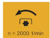
Abbildung 5: Warnbildzeichen Drehrichtung Motorzapfwelle
