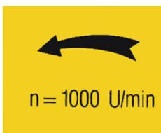
Motorzapfwelldrehzahl 1000 U/min CCW (gegen den Uhrzeigersinn)!
