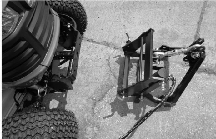
Bild 6: Positionieren des Frontkrafthebers.
