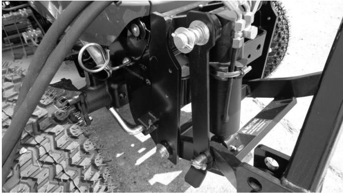
Bild 8: Frontkraftheber angebaut.
