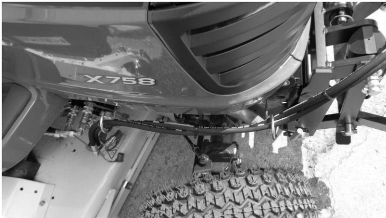
Bild 9: Verlegen der Hydraulikleitungen.
