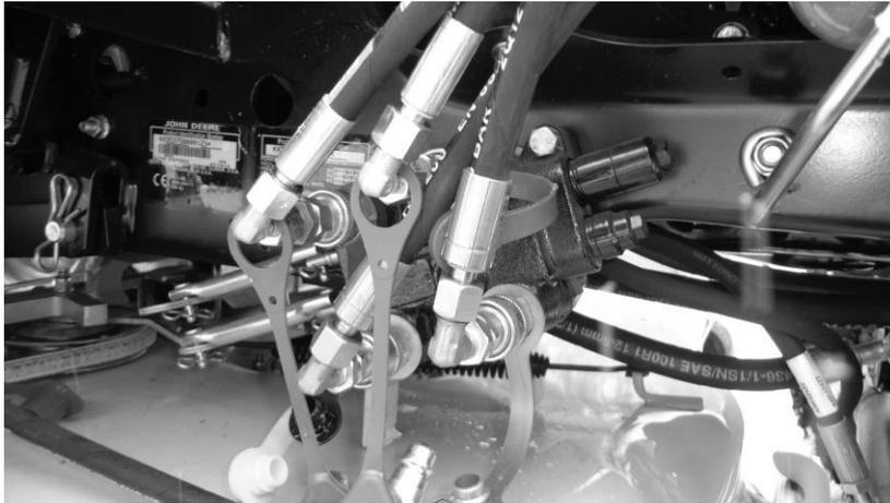
Bild 12: Hydraulikverlängerungssatz angeschlossen
