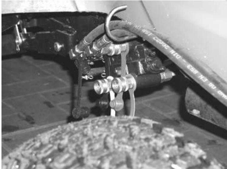
Bild 10: Anschließen der Hydraulikleitungen.
