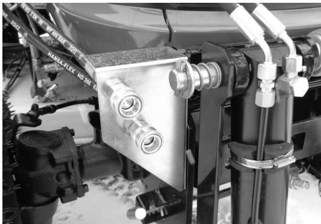
Bild 11: Halterung für Hydraulikverlängerungssatz
