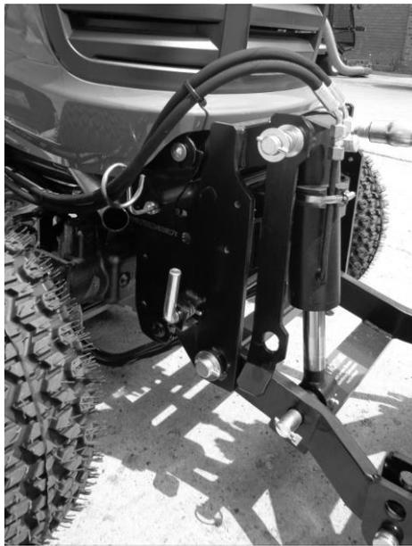
Bild 15: Absenksicherung entriegelt
