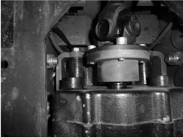
Bild 7: Gelenkwelle am Getriebeflansch befestigen
