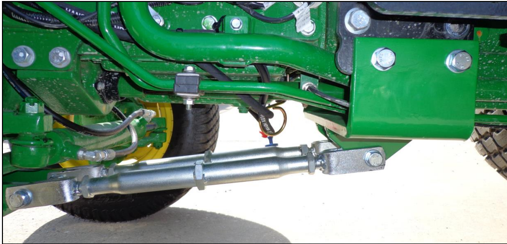
Bild 13: Rahmenunterzug an einem 4R
