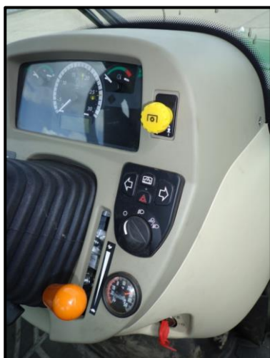
Bild 13: Zapfwellenschalter (Traktor mit Kabine)
