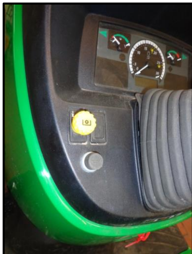
Bild 12: Zapfwellenschalter (Traktor ohne Kabine)
