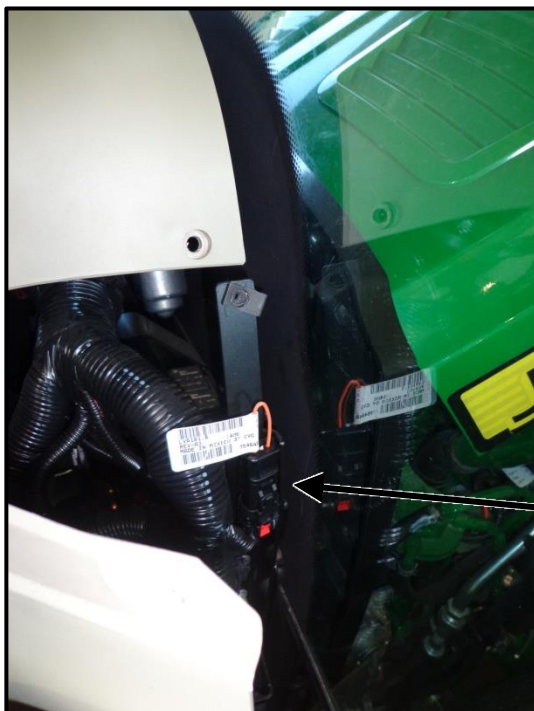
Bild 15: Kabel für Motorzapfwelle (Traktor mit Kabine)
