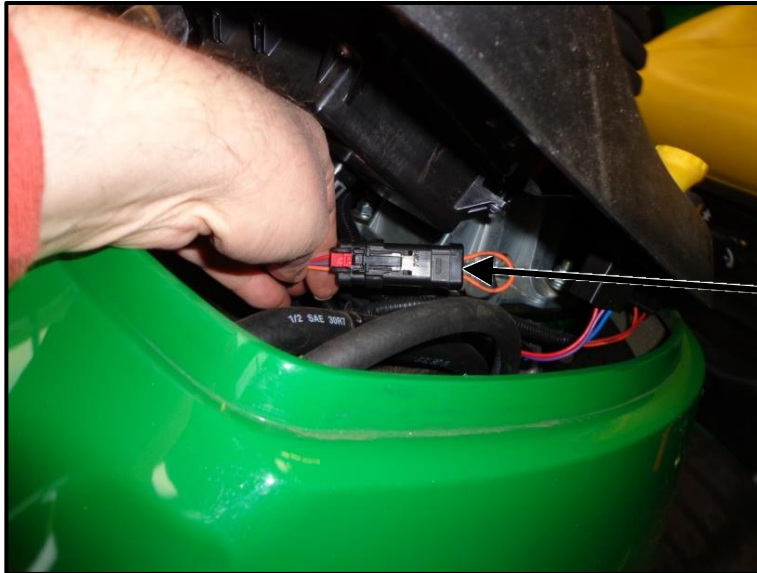
Bild 14: Kabel für Motorzapfwelle (Traktor ohne Kabine)
