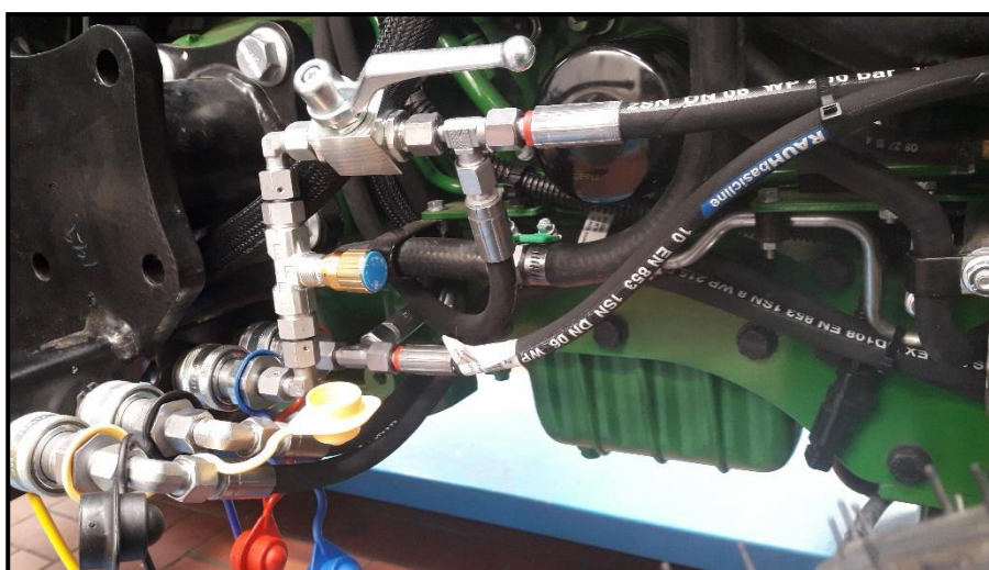
Bild 10: Anschluss an der Abzweigung
