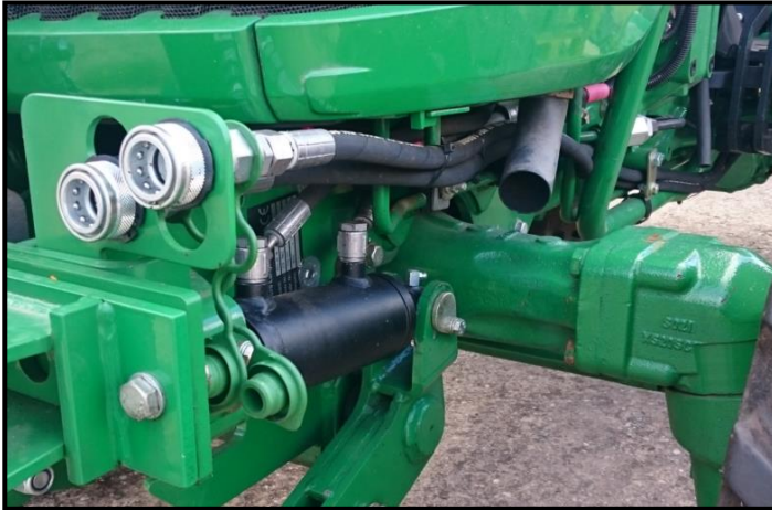
Bild 27: Hydraulikanschlüsse links vorne
