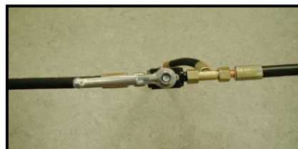
Bild 34: Absenksicherung entriegelt dargestellt
