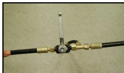
Bild 35: Absenksicherung verriegelt dargestellt
