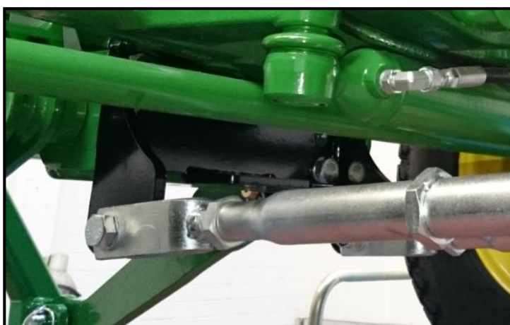
Bild 24: Rahmenunterzug an FKH befestigen
