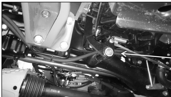
Bild 34: Schlauchverlegung Fahrzeugseite links
