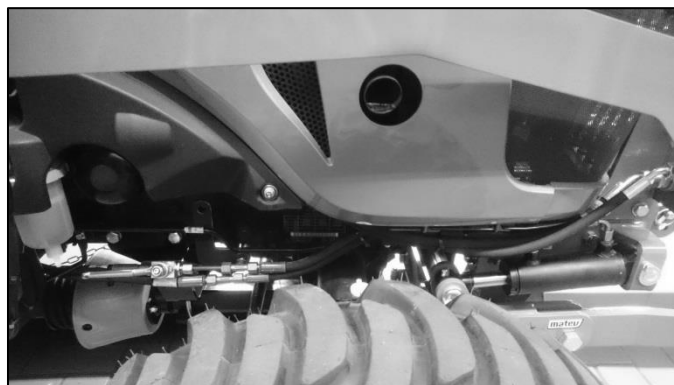
Bild 28: Schlauchverlegung Fahrzeugseite rechts
