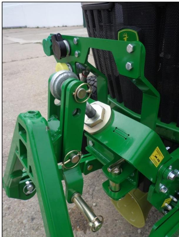
Abbildung 48: Arretierung am Kuppelträger
