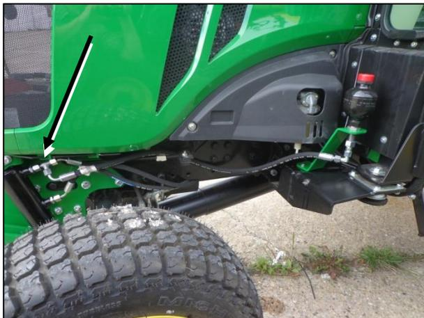
Abbildung 37: Druckspeicher – Hydraulik
