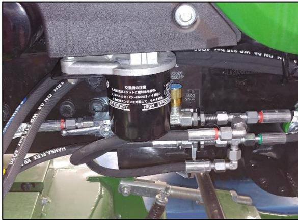
Abbildung 13: Hydraulikschläuche vom Steuergerät
