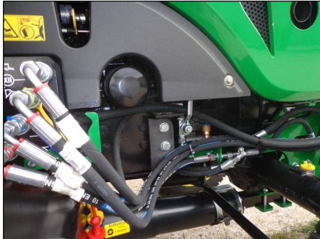
Abbildung 31: Rücklauf am Traktorrahmen
