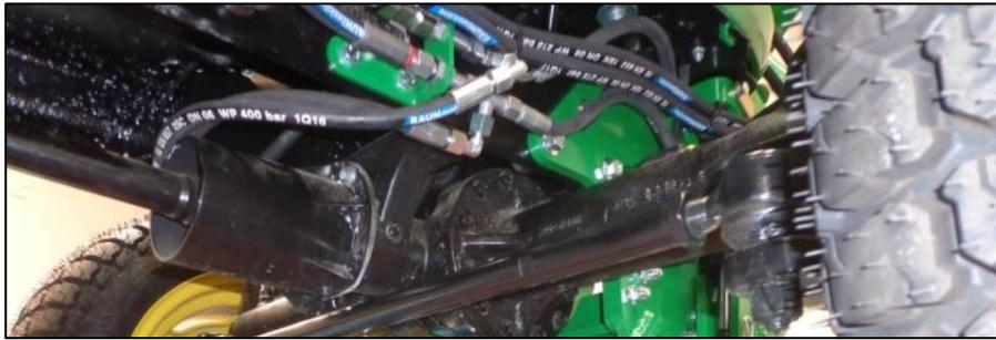
Abbildung 10: Verschlauchung linker auf rechten Hubzylinder
