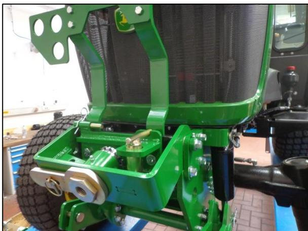
Abbildung 5: Zugmaul, montiert mit Oberlenker Kat. 0 und Hydraulikverlängerungssatz
