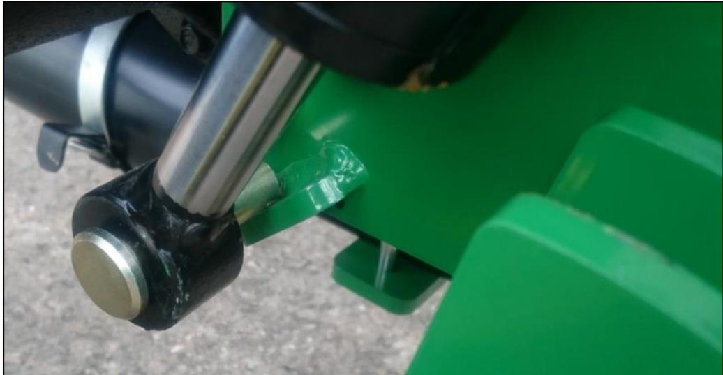
Abbildung 49: Arretierung für Hubzylinder
