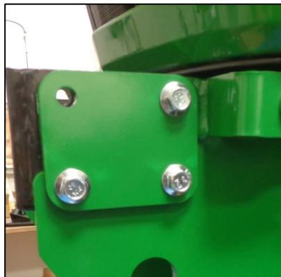
Abbildung 16: Seitenplatte montieren
