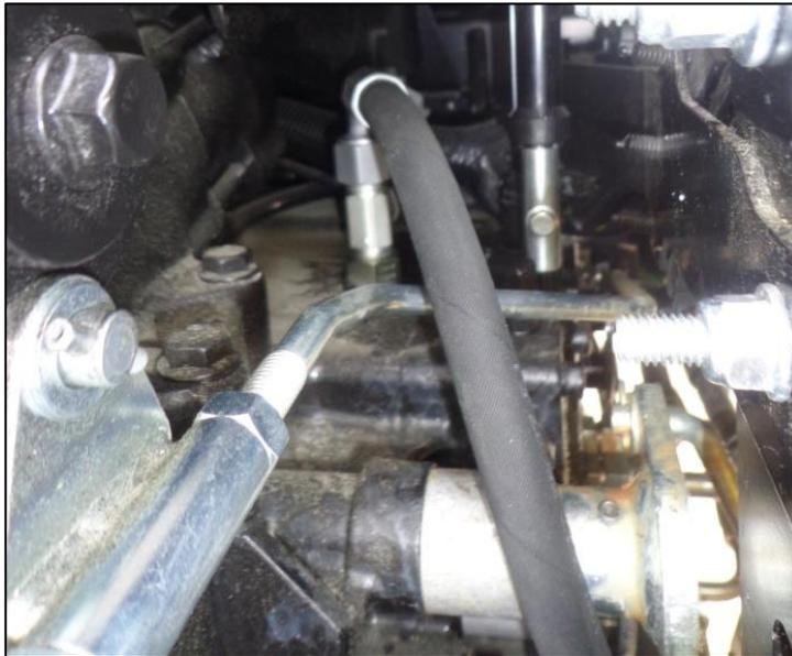
Abbildung 29: Montage Druckloser Rücklauf am Getriebe
