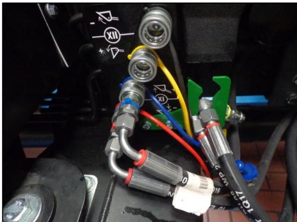
Abbildung 12: Kupplungen Frontkraftheber montieren
