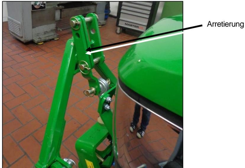
Abbildung 47: Arretierung für Kuppelträger Kat. 0
