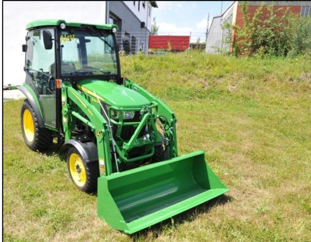
Abbildung 43: Frontkraftheber mit Frontlader
