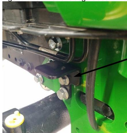
Halter für Hydraulikleitungen
