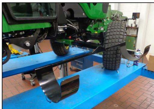
Abbildung 40: Doppelte Schlauchkelle
