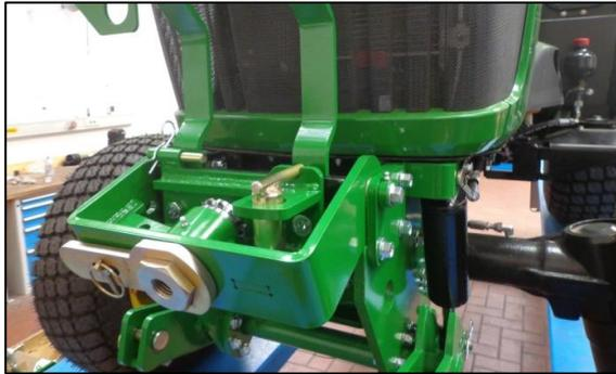
Abbildung 18: Oberlenker Kat. 0 montiert
